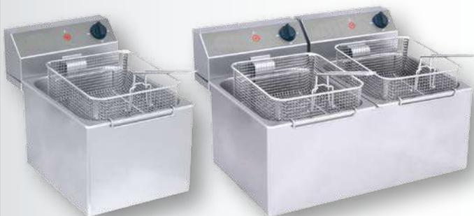
Vollständig aus Edelstahl. Ölwanne mit abgerundeten Ecken, für leichte Reinigung herausnehmbar. Thermostat-Schalter, Bereich 0-190 °C, mit Kontrollleuchte. Kaltzone zum Absetzen. Korb aus Edelstahldraht mit Abtropfgriff. Ummantelte Heizkörper. Aufklappbarer Kopfteil. Bei den Modellen mit 2 Wannen kann jede Wanne unabhängig von der anderen betrieben werden.
